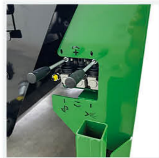
GESCHÜTZT: Steuerelemente im geschützten Rahmen verbaut.
