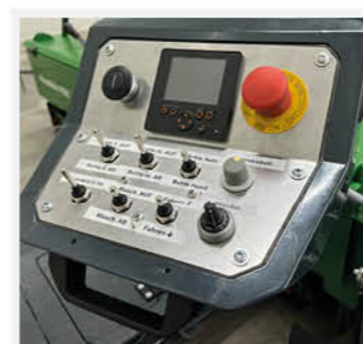
DIGITALISIERUNG: Steuerpanel mit Display für IOT und GPS Anwendung.
