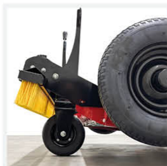
EINZIGARTIG: Ausklappbare Transporträder für enorme Bodenfreiheit zu Transportfahrten und zur Querfahrt durch Türen und enge Tore.
