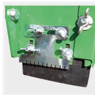
PRÄZISE: Einrichtung zur Kontrolle der Fräspur.
