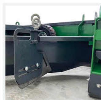
AUTOMATISIERUNG: Verbesserte Leitbleche für weniger Handarbeit.
