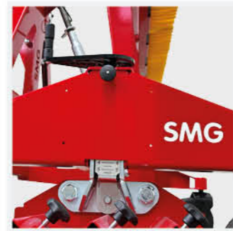
PRÄZISION: Einstellschrauben mit Arretierung und Skala.
