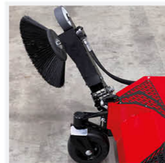
KOMPAKT: Arretierung für Seitenkehrbesen für sicheren Transport.
