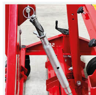
STABIL: Oberlenker zum Betrieb mit Dreipunktaufhängung.
