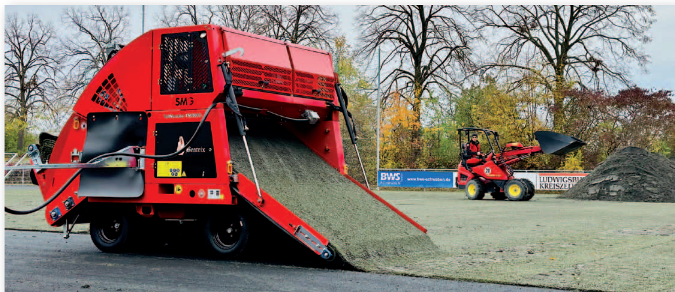
Specjalistyczna maszyna SMG – TurfMuncher TM2000D – do usuwania nawierzchni ze sztucznej trawy wraz z wypełnieniem
